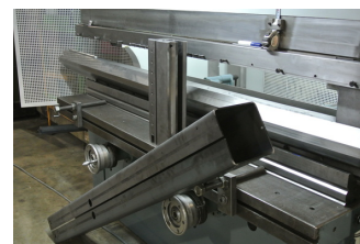
Werkzeug geöffnet, fertiges Produkt kann entnommen werden
