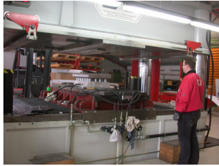
Prägewerkzeug mit hydraulischen Niederhaltern
